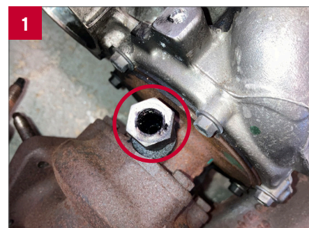
1 Ölzulauf- Der Anschluss der Öldruckleitung ist verkocht
